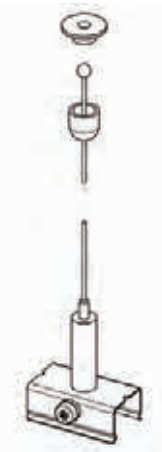
ST-A S/9000-KIT4/1500 Abhänge-Set Drahtseil + Befestigungs- klammer, 1500 mm
